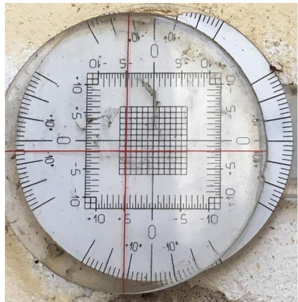
A sinistra: lettura del fessurimetro del 17-10-2016. A destra lettura del 24-01-2017
